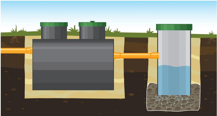
**Вариант 3:** Монтаж с отводом очищенной воды в фильтрующий колодец.
