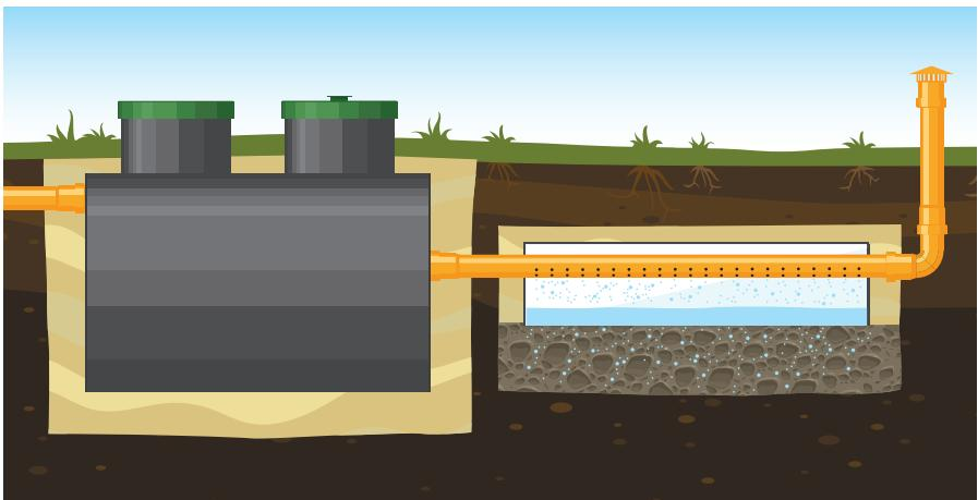
**Вариант 4:** Монтаж с отводом очищенной воды в дренажный элемент.
