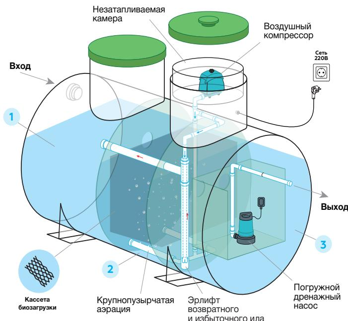
Такая конструкция обеспечивает необходимую очистку стоков, соответствующую установленным санитарно-гигиеническим требованиям СанПин 2.1.5.980-00 «Гигиенические требования к охране поверхностных вод».
